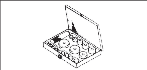
Treiber für Kopfrohr-Außenlaufring, Ø 55: 57001-1446
